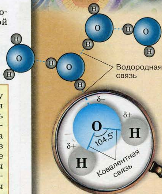
1.1. Строение молекулы воды и образование водородных связей между молекулами
